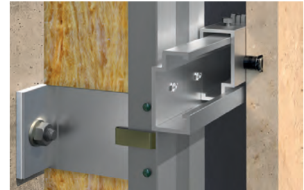
Fassadenquerschnitt mit Bündigmontage
