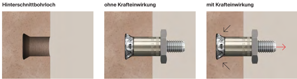
Hinterschnittbohrloch und Verhalten des Zykonplattenankers FZP II mit und ohne äußere Krafteinwirkung
