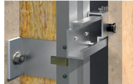
Fassadenquerschnitt mit Innengewindeanker
