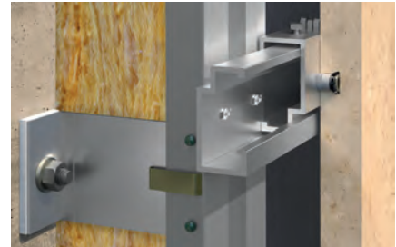
Fassadenquerschnitt mit Innengewindeanker
