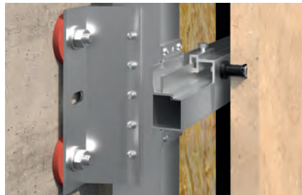
SystemOne im Fassadenquerschnitt mit Naturstein
